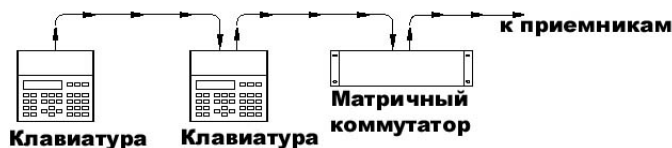
Рис. 5. Расположение матричного коммутатора в типовой системе видеонаблюдения.
